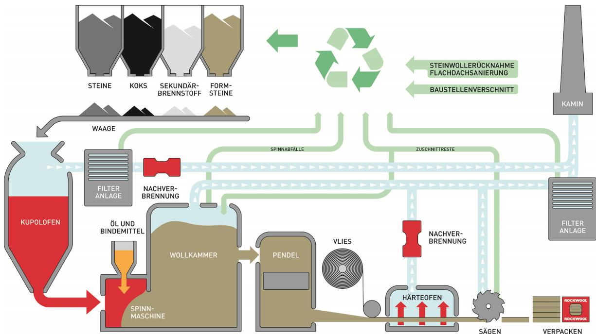
Die Rohwolle wird in Sammelkammern auf unter Unterdruck stehenden Transportbändern abgelegt. Optional können anschließend Kaschierungen aufgebracht werden. (Die entsprechenden Umweltwirkungen hierzu werden im Anhang angegeben.) Das ggf. kaschierte Rohvlies wird Härteöfen zugeführt, in denen 200-300°C heiße Luft durch die Wollmasse gesaugt wird, wobei sich die Bindemittel zu Duroplasten vernetzen. Schließlich wird das Produkt mittels Sägen in Form gebracht.
